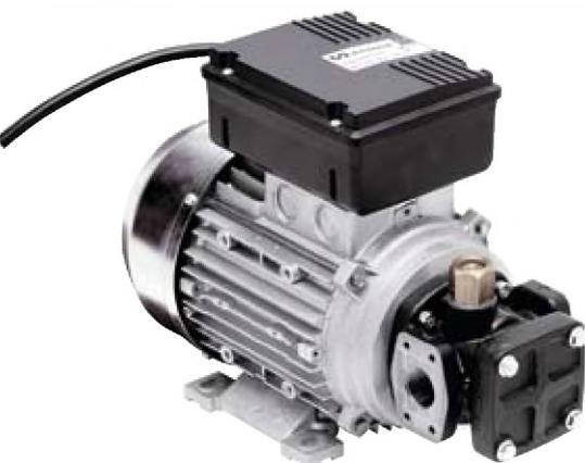
Шестеренчатый электронасос с внутренним зацеплением для смазочных материалов. Двигатель 230 В - 50 Гц (однофазный) или 380 В - 50 Гц (трехфазный), в зависимости от модели, степень защиты IP-55, двухпозиционный переключатель. Чугунный корпус, шестерни и байпасный клапан из спеченной стали. Двигатель с монтажной опорой, насос может монтироваться горизонтально на плоскую поверхность или вертикально на стену.
