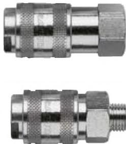
Латунные, с никелированным корпусом, изнашиваемые части из нержавеющей стали. Совместимость: US MII C4109 - ISO 6150 B12. Пропускная способность: 1000 л/мин.
