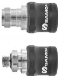
Быстроразъёмные муфты безопасности для сжатого воздуха. Одношаговое разъединение и выхлоп воздуха быстро понижает давление в системе. Изготавливаются из нержавеющей стали, никелированной латуни, нитрильного каучука и технополимера. Муфты соответствуют стандарту ISO 6150 B12. Пропускная способность: 1200 л/мин. Давление: от 1 до 15 бар.
